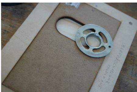
Damit die Vögel auch in das Vogelhaus kommen, muss die Vorderseite mit einer Öffnung versehen werden. Diese haben wir mithilfe einer Schablone, die im CREAPOLIS Makerspace zur Verfügung steht, und der Oberfräse ausgefräst.
