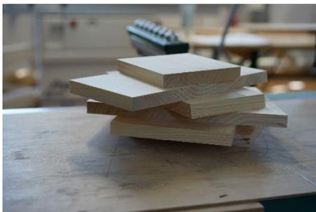
Die an der Abrichte erzeugten Ebenen, werden am Dickenhobel genutzt, um ein Brett auf die vorgegebene Stärke anzupassen. Hierzu wird die plane Ebene auf dem Tisch platziert. Die Oberseite wird mit der Hobelwelle dazu plan abgetragen, sodass eine Parallelität zwischen der Ober- und Unterseite entsteht.
