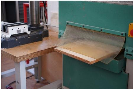
Im zweiten Schritt wird mit der Formatkreissäge besäumt. Das bedeutet, dass die Ränder, die teils noch mit Baumrinde besetzt sind, mit einem Längsschnitt abgetrennt werden.
