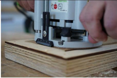
Für die Erstellung eigener Schablonen muss bei der Dimensionierung darauf geachtet werden, dass das Loch der Schablone größer ist, da zwischen dem Fräseraußendurchmesser und dem Durchmesser des Anlauftrings ein gewisser Abstand besteht.
