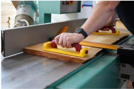
Bevor es mit dem Bau des Vogelhauses losgehen kann, muss das Holz erst mit der Tauchsäge zugesägt werden. Das sägeraue Vollholz wird dabei auf Abschnitte von etwa 1,20 Meter abgelängt. Ein Vogelhaus entsteht demnach aus einem 1,20 Meter langen Abschnitt.
