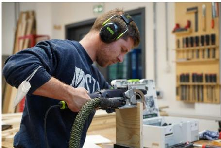
Die bereits angezeichneten Bohrungen und Fräsungen müssen nun, damit die einzelnen Bretter zusammengesteckt und verleimt werden können, mit entsprechenden Montageöffnungen versehen werden. Dazu haben wir die Dominofräse und die Standbohrmaschine verwendet.
