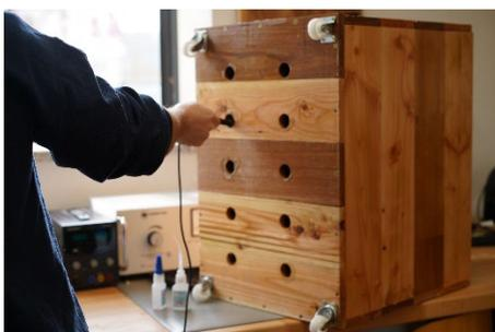
Zum Abschluss haben wir die Folie an den Stellen, an denen Löcher im Boden sind, mit dem LötKolben durchbohrt, damit das Wasser abfließen kann. Das hat den Vorteil, dass die Kanten eine saubere Schmelzkante haben und nicht ausreißen. Du solltest dabei unbedingt eine FFP2-Maske tragen und für gute Durchlüftung sorgen.
