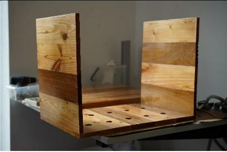
Bevor die Bodenplatte mit den weiteren Elementen verschraubt wurde, haben wir auch hier Löcher vorgebohrt. Wir haben zunächst die kurzen Seiten mit der Bodenplatte verschraubt
