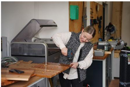
Beim Verschrauben der einzelnen Elemente solltest Du darauf achten, dass Du weit genug entfernt von den Kanten bohrst, sonst könnte das Holz splintern. Unser Holz ist 1,5 cm dick, also haben wir im Abstand von 7 mm zur Kante gebohrt. Damit nichts splittert, sollte ein Abstand von der Hälfte der Holzdicke zur Kante eingehalten werden.
