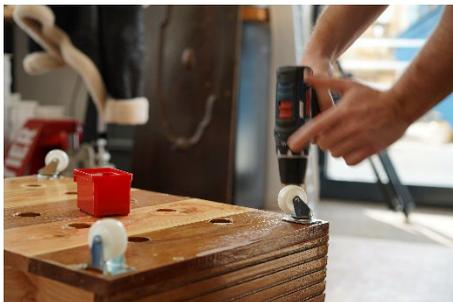
Damit der Pflanzkübel nicht direkt auf dem Boden steht und leicht bewegt werden kann, haben wir vier Räder mit jeweils vier Schrauben an der Bodenplatte festgeschraubt.
