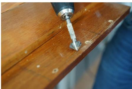
Wir haben Holzschrauben mit einer Länge von 3 cm verwendet und alle Löcher in der Bodenplatte (jeweils drei an den kurzen und fünf an den langen Seiten) erst mit einem Drei- und dann mit einem Fünfschneiderbohrer vorgebohrt. Zusätzlich haben wir die vorgebohrten Stellen mit einem Senker vertieft, damit die Schrauben im Holz „verschwinden“ und keine Kanten entstehen.
